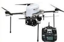
最新のフライトコントローラーPixhawk2と、5GHz帯を使用したハイビジョン映像伝送機能等を搭載しています。標準飛行時間は20分程度で、飛行ログの抜出・解析が可能です。また別の6枚羽機体も含めて、用途・要望に応じカスタム設定も対応しています。
