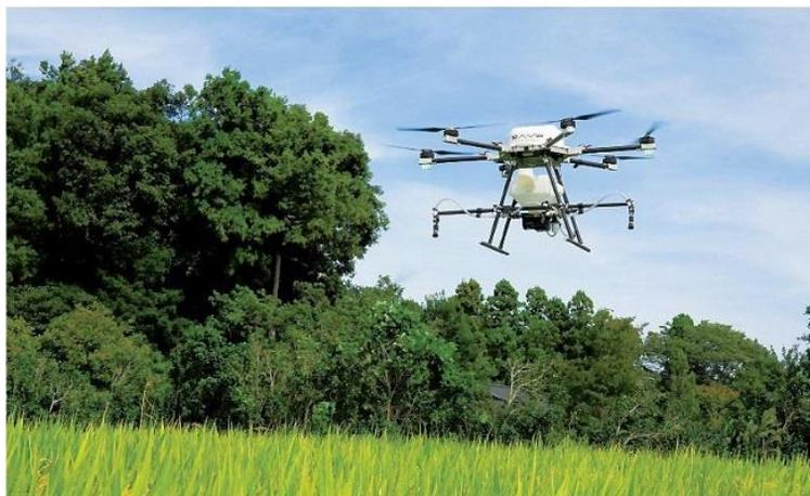
約5分のワンフライで4.0リットル(0.5ha)の散布が可能です。レーザーレンジファインダー搭載で農地の起伏に合わせ飛行し、操縦を補助します。30秒程で取替可能な顆粒散布装置もあります。
